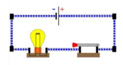
**Stromstärke I** - Sie beschreibt die "Menge an Elektronen" (Ladung Q) , die in einem Zeitabschnitt (Zeit t) an einer Stelle vorbeifließen. Man kann sie sich wie den Verkehrsfluss auf einer Autobahn vorstellen. 1200 Autos in 60 Minuten stellen einen stärkeren Strom dar als 2000 Autos in 120 Minuten. Sie wird in Ampere (A) gemessen.
